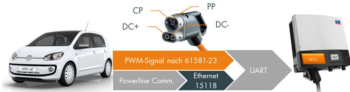
Abbildung 6: Kommunikation zwischen Fahrzeug und Wallbox (PWM: Puls-Weiten-Modulation, UART: Universal Asynchronous Receiver Transmitter)
